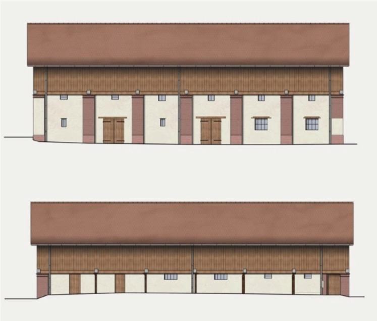
BROCAS · FAÇADES NORD ET SUD, RENDU DES MATÉRIAUX
